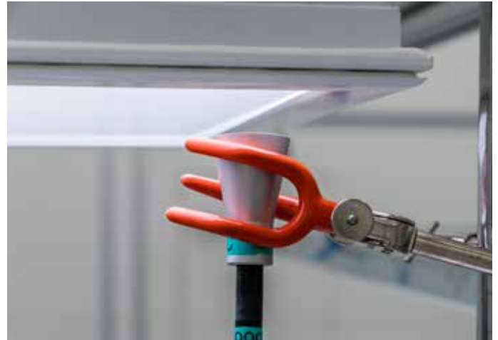
Die Saugrohre werden verwendet, um Partikel über einen Zeitraum von 100 Minuten zu sammeln
